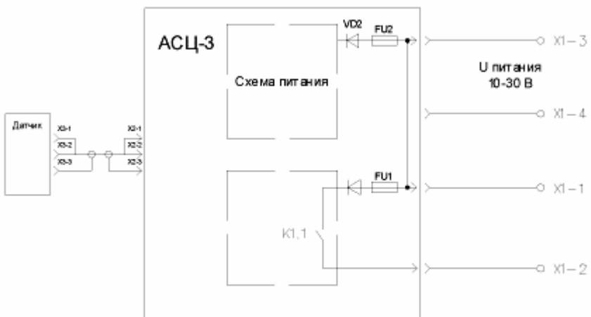
Схема подключения по постоянному току
